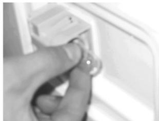
Se la luce non funziona più, staccare sempre la spina del congelatore prima di sostituirla. Spingere il coperchio dentellato della lampada sui lati lunghi e tiralo su. Ruotare la lampadina elettrica, toglierla e sostituirla con una nuova. Riposizionare il coperchio della lampadina. Inserisci nuovamente la spina.
