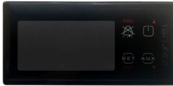
Quando il prodotto viene messo in funzione, il display del termostato lampeggia per alcuni secondi, in attesa del controllo di tutti i collegamenti elettrici. Se tutti i collegamenti sono conformi alle norme di sicurezza, il valore della temperatura verrà mostrato sullo schermo del termostato. Il valore della temperatura impostato è il valore di temperatura ottimale per i prodotti contenuti nell'isola.
