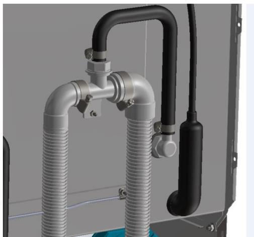
Sostituire il troppo pieno originale della macchina con quello forato in dotazione al kit installazione pompa di scarico
